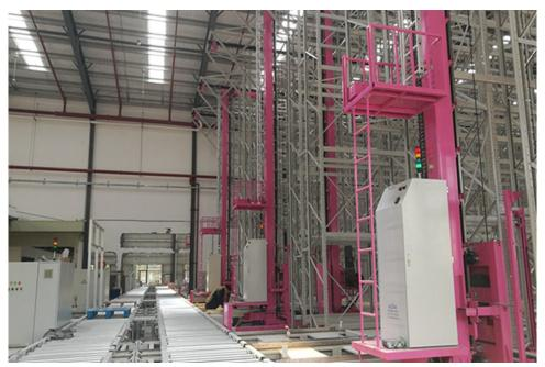
自动化立体库作为现在物流系统中的重bai要组成部分,是du一种用于存放货物的多层高架仓库系统。它由立体货架、堆垛机、输送机、搬运设备、托盘、管理信息系统及其他wai围设备构成。能按指令自动完成存储作业,并能对库存货位进行自动管理,在现代化企业中发挥了重大作用。自动化立体bai仓库简称立体仓库.一般是指采用几du层、十几层乃至几十层高zhi的货架储存单元货物,用相dao应的物料搬运设备进行货物入库和出库作业的仓库.由于这类仓库能充分利用空间储存货物,故常形象地将其称为"立体仓库".自动化立体仓库是现代物流系统中迅速发展的一个重要组成部分,它具有节约用地、减轻劳动强度、消除差错、提高仓储自动化水平及管理水平、提高管理和操作人员素质、降低储运损耗、有效地减少流动资金的积压、提高物流效率等诸多优点.与厂级计算机管理信息系统联网以及与生产线紧密相连的自动化立体仓库更是当今CIMS(计算机集成制造系统)及FMS□明确自动化立体仓库与上游、下游衔接的工艺过程。韶关本地自动化立体仓库
